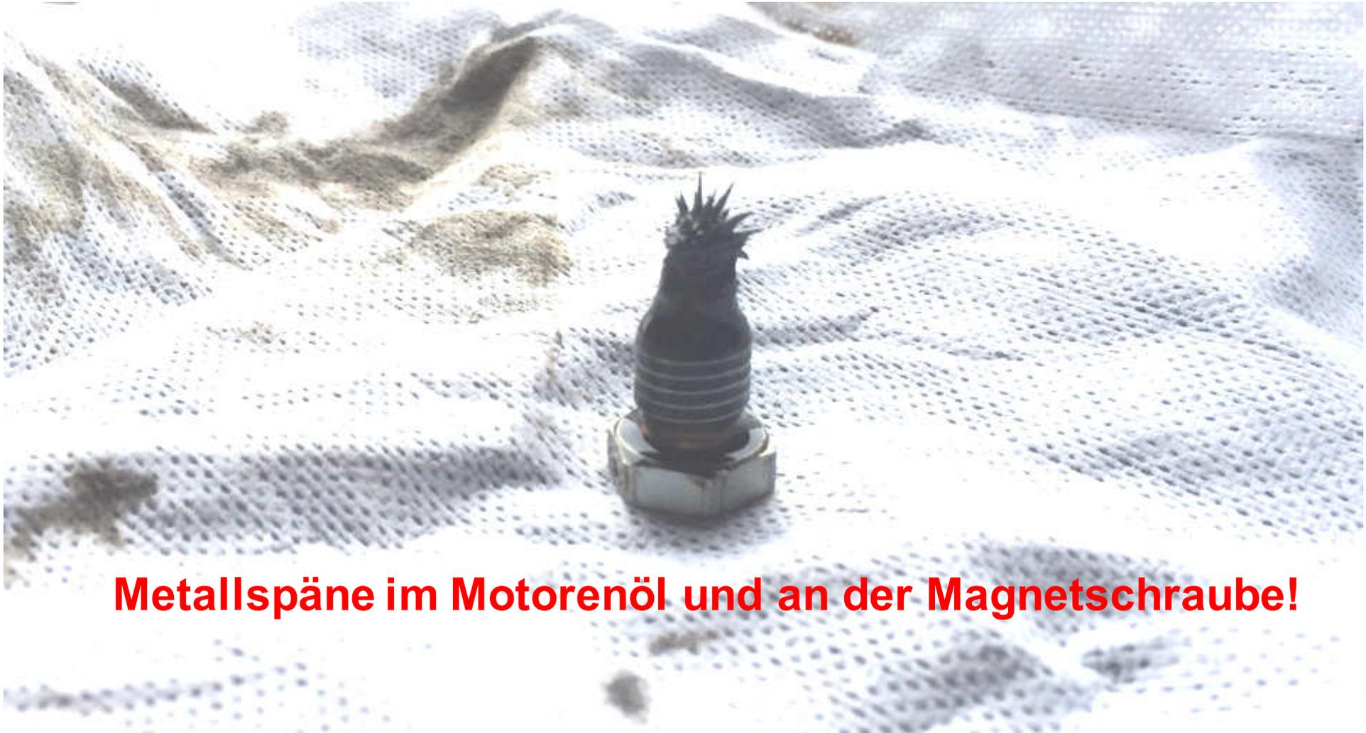
**Metallspäne im Motorenöl und an der Magnetschraube!**
