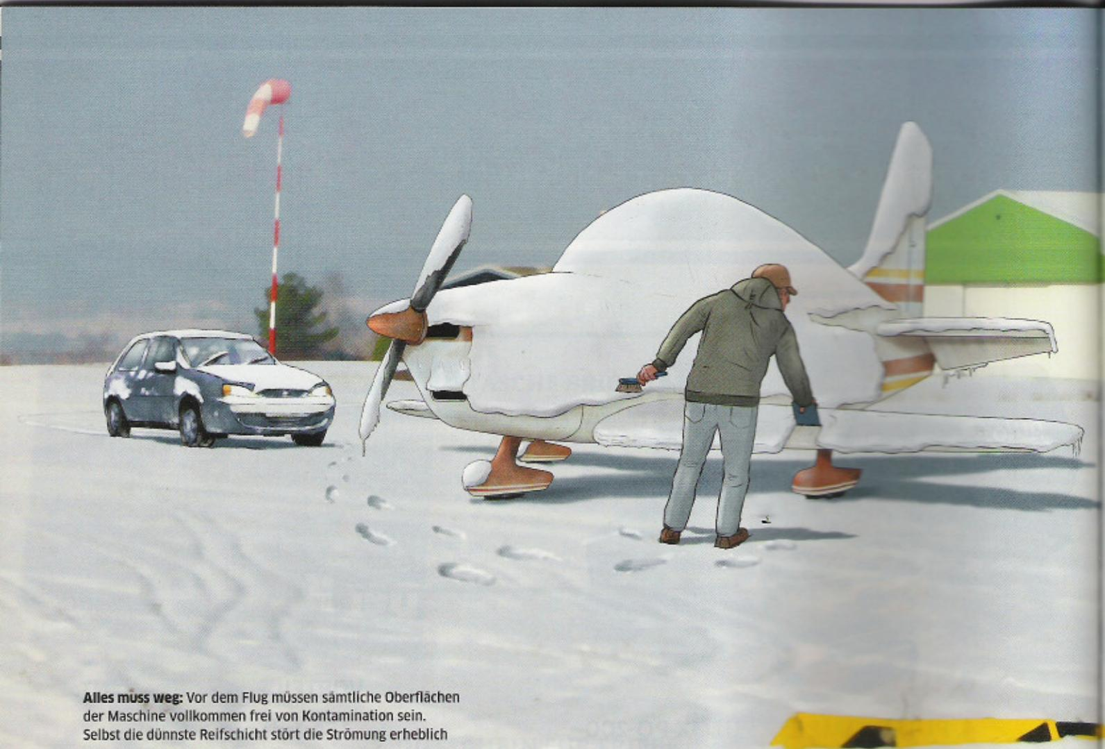
**Alles muss weg:** Vor dem Flug müssen sämtliche Oberflächen der Maschine vollkommen frei von Kontamination sein. Selbst die dünnste Reifschicht stört die Strömung erheblich
